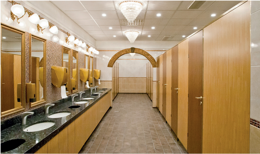
LTT 24 mm, polttomaalattu alumiiniprofiilirunko, erikoishelat, Keskisen Tavarapuoti, Tuuri
